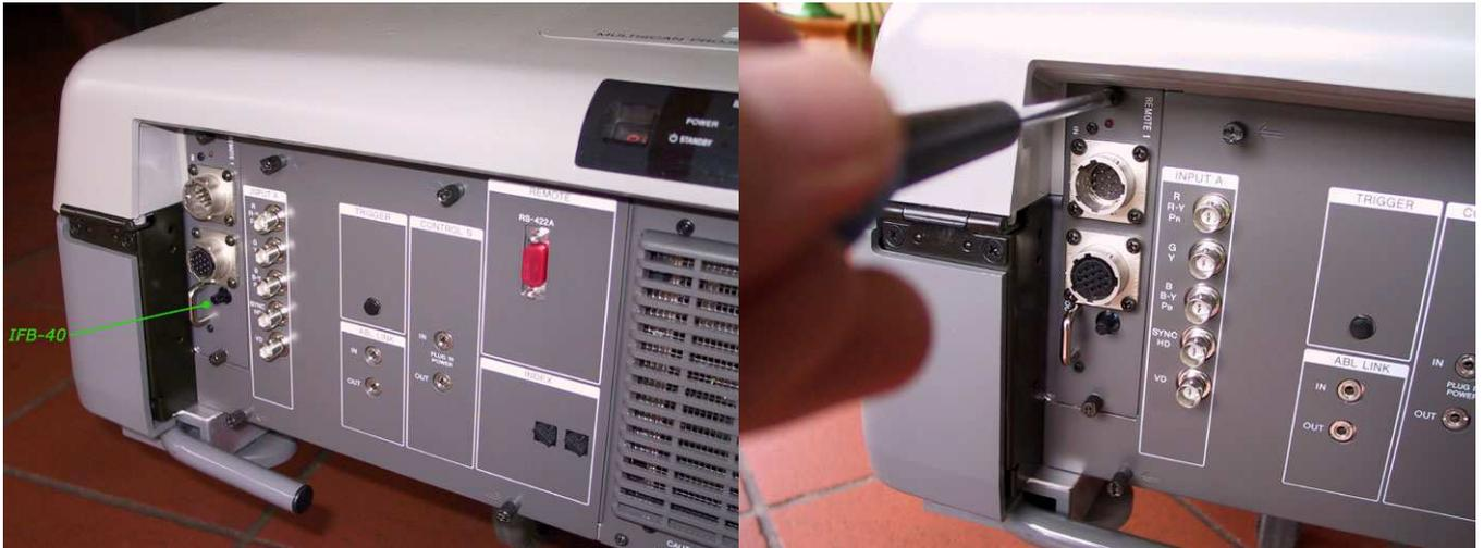
Localizzate lo slot di espansione IFB (B input) dove si trova una IFB-40 – Usando un cacciavite a croce, svitate le due viti
