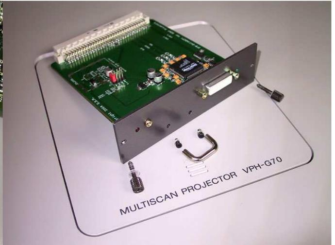
Ora abbiamo due viti di tenuta, un archetto e le sue due viti – Posizionamento delle parti sulla nuova scheda IFB-DVI
