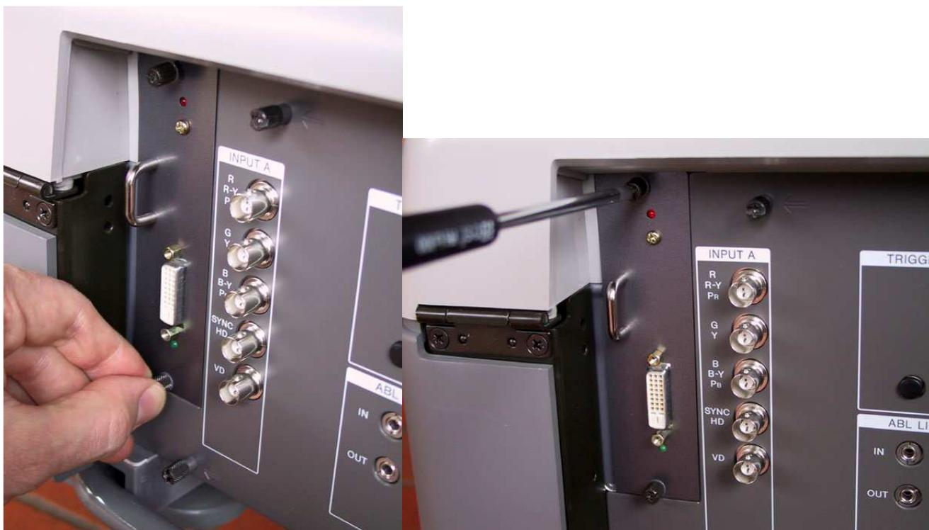
Spingete la card a fondo all'interno del suo slot ed avvitate la vite inferiore – Avvitate quella superiore col cacciavite.
